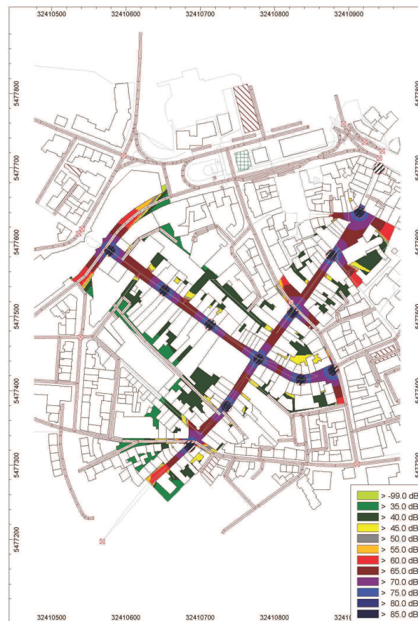
Abb. 1: Beispielhafte Anordnung „Smarter Sirenen“ in der Fußgängerzone von Kaiserslautern, um eine adäquate Abdeckung und Erreichbarkeit der Menschen zu gewährleisten.
